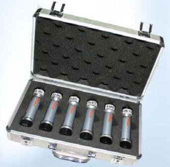
\* En option : Kit de 6 étalons quartz pour calibration automatique
